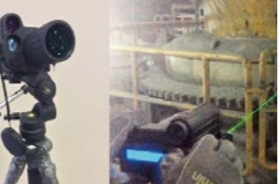
Los científicos de la Universidad de Concepción desarrollaron un dispositivo óptico láser transportable llamado Micro-LIDAR para la detección de material particulado emitido en chimeneas y calderas a biomasa. Éste permite monitorear la calidad del aire y fiscalizar in situ o remota durante eventos de emergencia ambiental en zonas saturadas.
