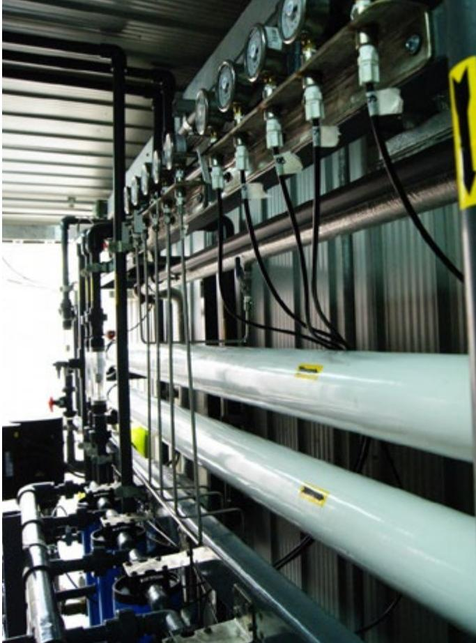
Sistema de nanofiltración.
